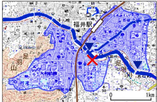
図 8 足羽川の破堤・越水による浸水域(2004 年福井豪雨) ×：破堤 ▼：越水 (福井市資料)
