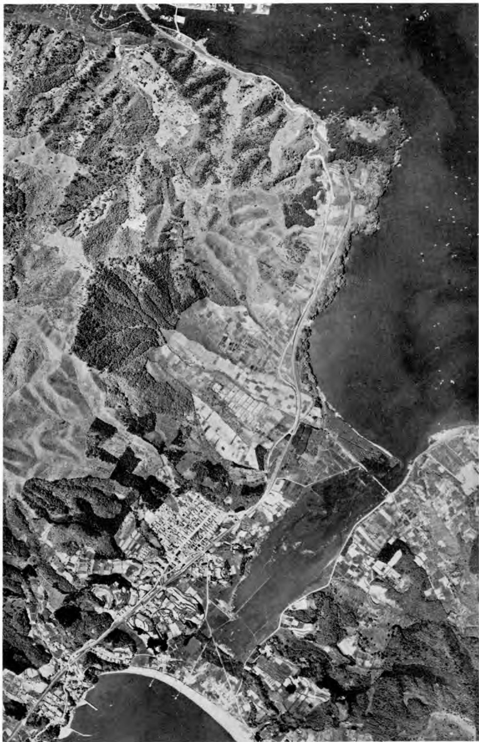
写真 5 津波直後の岩手県山田町船越 右側が山田湾、左側が船越湾、津波の時は両方の湾の水位は同時に上昇せず、一方が高くなる時は他方が低くなる。右側の山田湾よりの浸水が大きかった。
