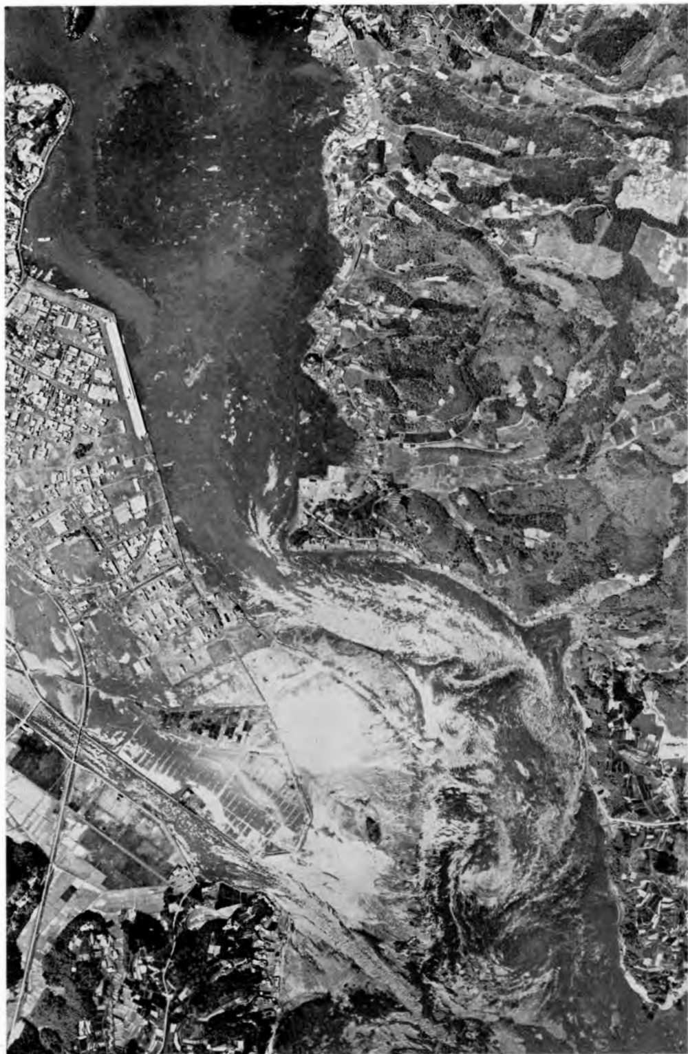
写真 4 津波直後の気仙沼 気仙沼湾は平常カキの筏が整然と並んでいるのであるが、津波で完全に攪乱された。左下到大川河口が見られるが、この川のデルタのやや北側が破堤している。この破堤地点は大川の旧河口にあたる。
