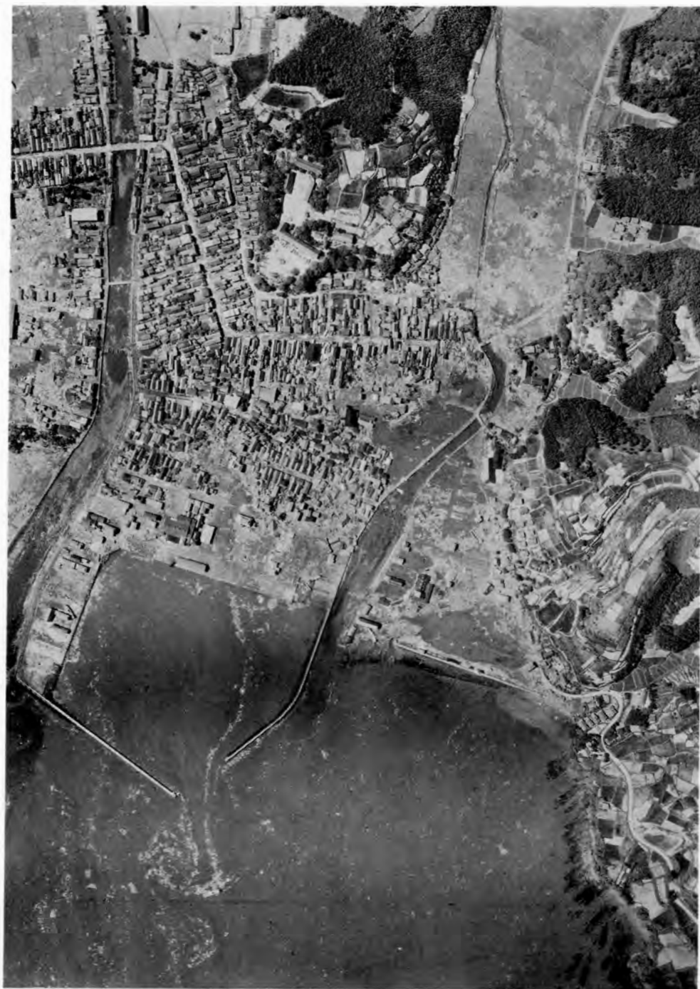
写真1 津波直後の志津川町 志津川町はほとんど全域津波におそわれ、死者40名をはじめ、多数の家屋が破壊され、チリ地震津波では日本最大の被害を出した。海面及び水田地帯には家屋の破かいによつて生じた流木が集積し、また河川を津波が溯つたため、河には橋桁だけが残っている。
